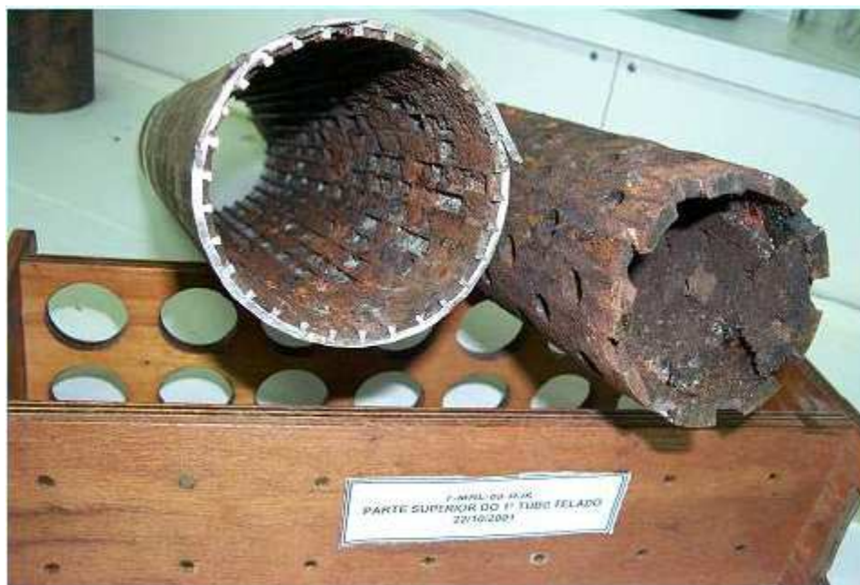
Figura 4.5 – Gravel Packing com suas telas completamente incrustadas.
