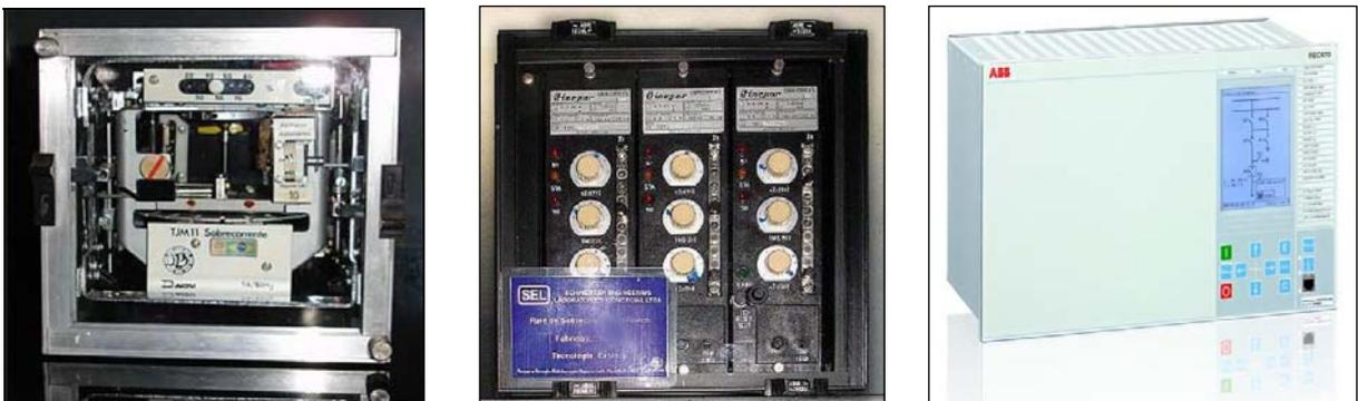
**Figuras 2.6 (a) (b) (c)** – À esquerda Relé Eletromecânico de sobrecorrente, ao centro relé estático e à direita relé digital
