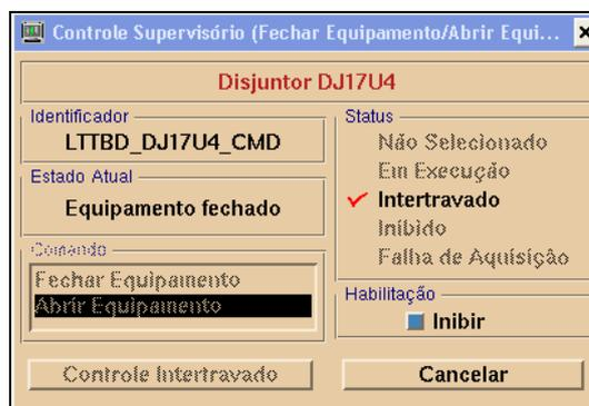
Figura 3.14 – Tela de Controle de Disjuntor – Equipamento sem permissão de controle (intertravamento).
