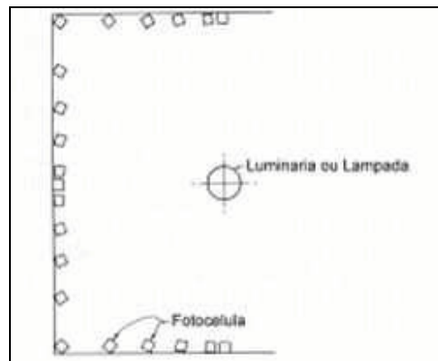
Figura 3.13 - Goniofotômetro com fotocélulas fixas [14].
