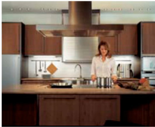
Figura 6.3 – Exemplo de um sistema de iluminação localizada [21].
