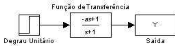
Figura 3.1 – Diagrama de blocos para sistema de 1ª ordem com um zero e entrada degrau unitário.
