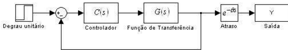
Figura 5.5 – Diagrama equivalente para Preditor de Smith.
