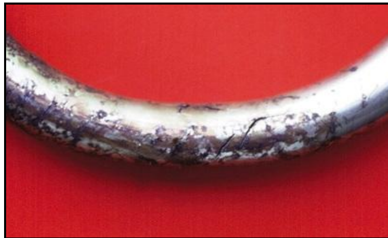
Figura 2.7 – Parte de tubulação de aço inoxidável AISI 304 para vapor d'água, fraturada por corrosão sob tensão em trecho curvo [10]
