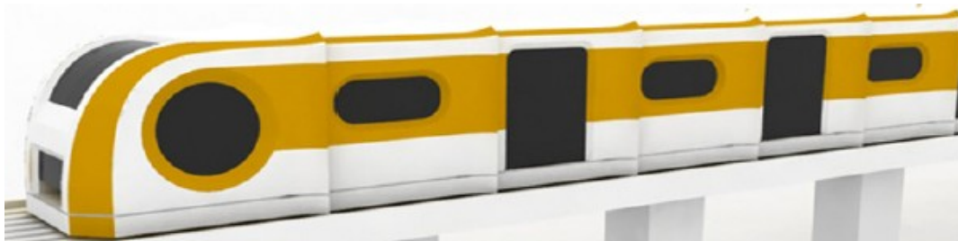
Figura 14 – Projeto conceitual do Maglev Cobra para velocidade entre 30-90 km/h (David, 2006)
