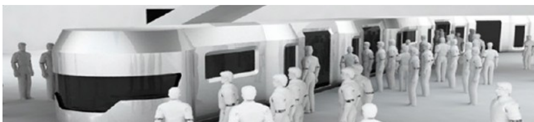
Figura 15 – Projeto conceitual do Maglev Cobra para velocidade até 30 km/h (David, 2006)
