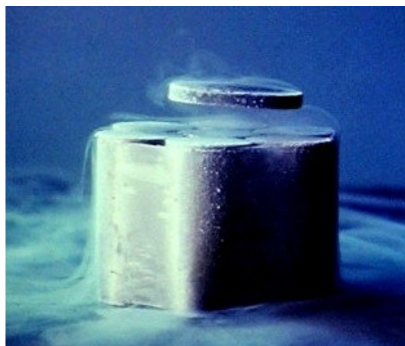
Figura 8 - Demonstração do efeito Meissner em supercondutores ( www.superconductors.org , 2007)
