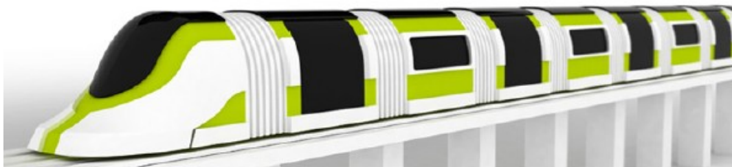
Figura 13 – Projeto conceitual do Maglev Cobra para velocidade > 100 km/h (David, 2006)
