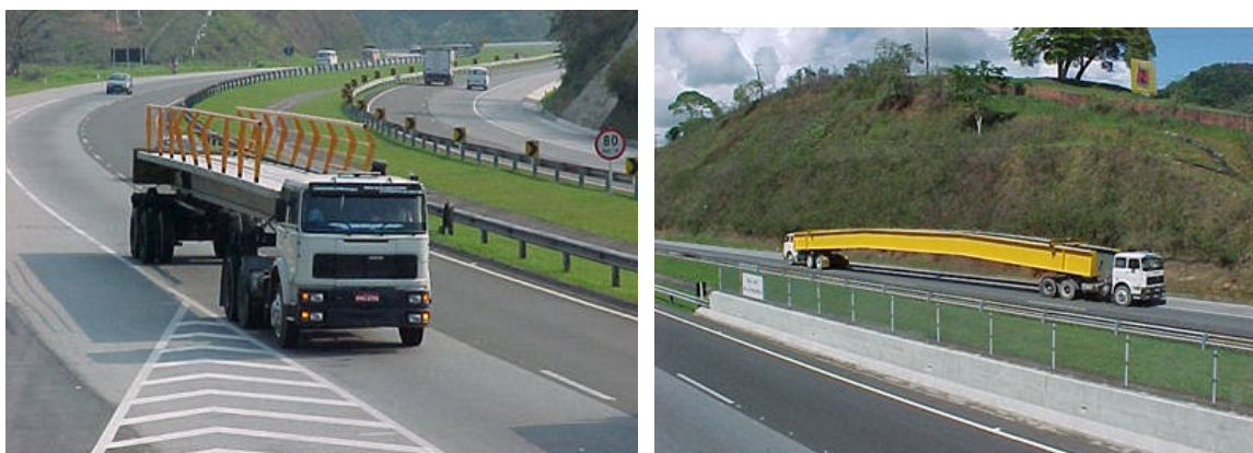
Figura 26 - Exemplos de transporte de vigas bi-apoiadas pelo sistema cavalo-reboque (site da Premag, www.premag.com.br – RJ, 2007)
