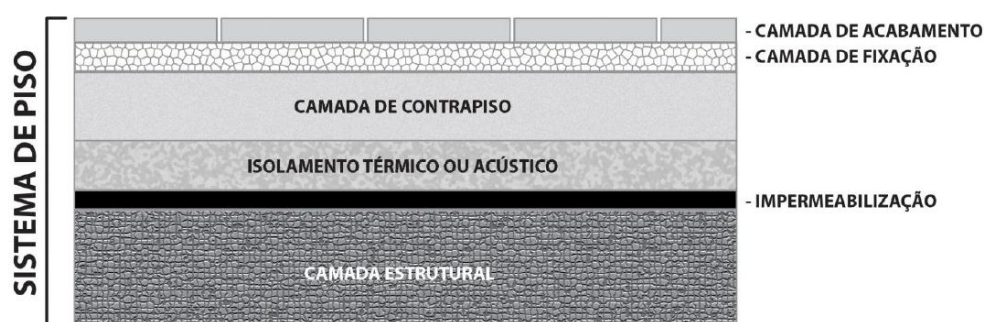
Figura 2 - Exemplo genérico de um sistema de pisos e seus elementos (ABNT NBR 15575-3)
