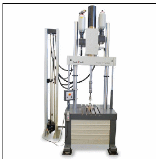
Figura 7.1.1 – Máquina de ensaio de fadiga por tração-compressão.
