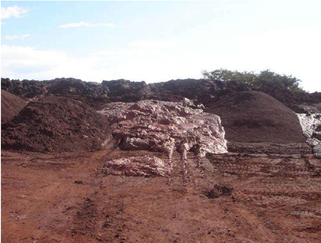
Figura 1: Rejeito em pasta, disposto por caminhão. (Araújo, 2006)
