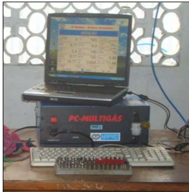
Figura 3.2 Analisador de gases de descarga NAPRO e software de visualização de dados
