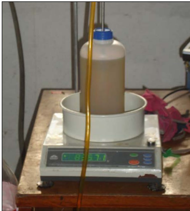
Figura 3.5 Medidor de consumo de gasolina
