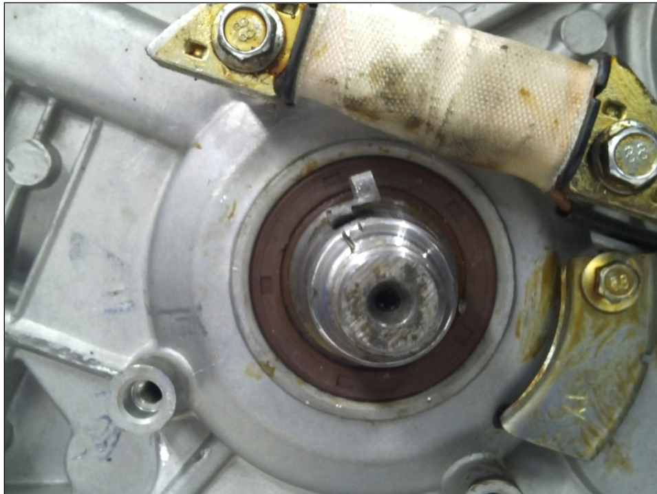
Figura 4.1 Modificação do ponto de ignição - detalhe da chaveta
