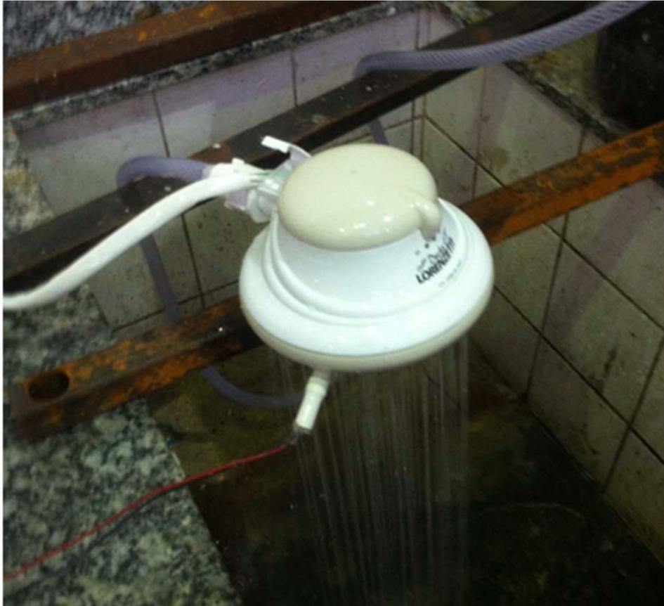
Figura 2.11: Adaptação do sensor de temperatura na saída do chuveirinho
