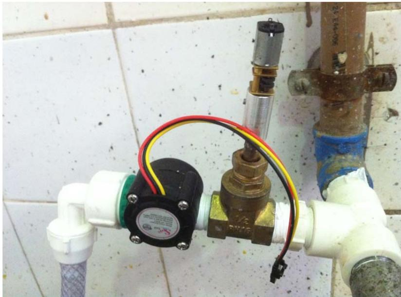
Figura 2.10: Montagem da transmissão do motor e a válvula gaveta.
