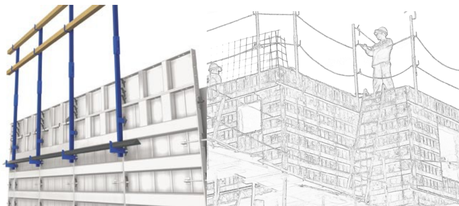
Figuras 27 e 28. Montantes do guarda-corpo e utilização de corda para fechamento do guarda-corpo, respectivamente.
