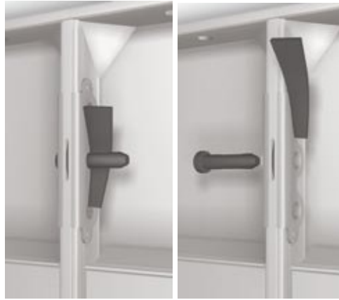
Figuras 21. Posicionamento das cunhas.
