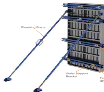
Figura 3. Travamento das fôrmas de paredes. (Imagem retirada do manual técnico do fabricante, 2011)
