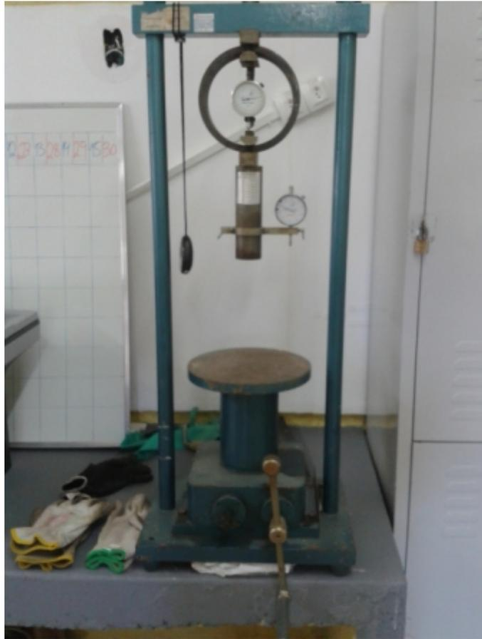
Figura 15 - Aparelho usado no ensaio CBR (Autor)
