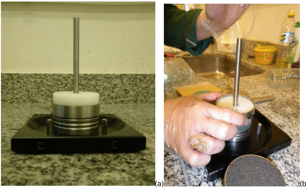
Figura 3.8 – (a) Dispositivo para a retirada do anel; (b) anel de DSS sendo retirado (Jannuzzi, 2013).
