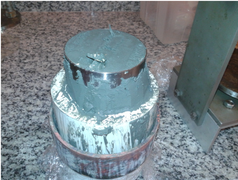
Figura 3.15– Moldagem do corpo de prova, profundidade média de 3,55 m.
