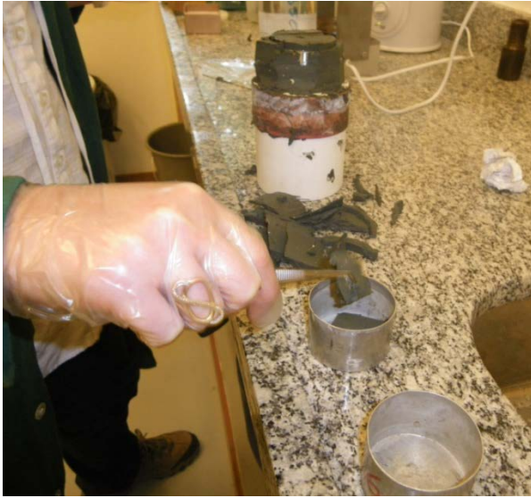
Figura 3.5 – Retirada da amostra do tubo amostrador e determinação do teor de umidade (Jannuzzi, 2013).
