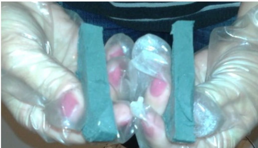
Figura 3.16 – Amostra seca e aberta após a realização do ensaio, profundidade média de 3,55 m.
