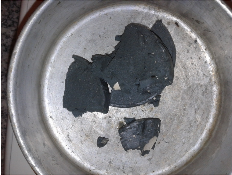
Figura 3.21 – Corpo de prova após a realização do ensaio ainda com fragmentos de conchas, profundidade de 3,63 - 3,67 m.
