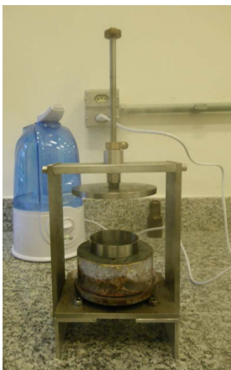
Figura 3.4 – Cravação do anel de DSS para a moldagem do corpo de prova (Jannuzzi, 2013).
