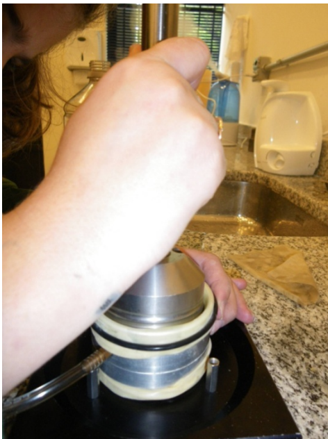
Figura 3.10 – Top cap sendo colocado no topo do corpo de prova (Jannuzzi, 2013).
