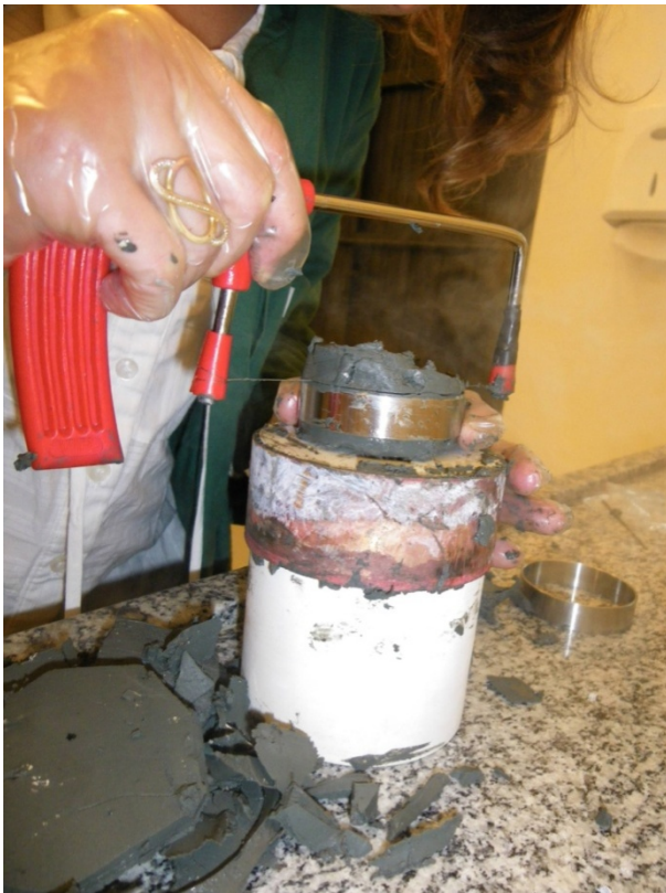
Figura 3.6 – Moldagem da amostra (Jannuzzi, 2013).
