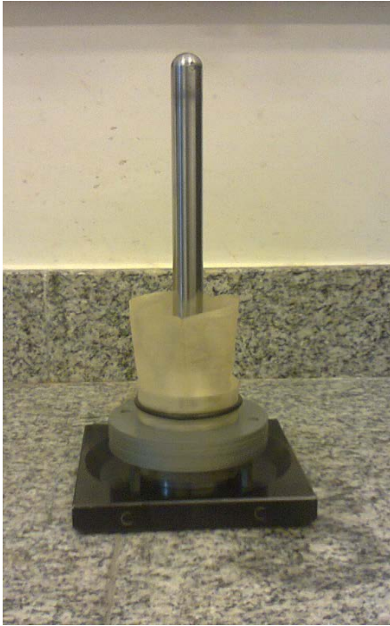
Figura 3.11 – Anéis justapostos e o-ring do top cap colocados no corpo de prova (Jannuzzi, 2013).
