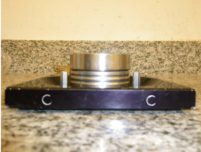
Figura 3.7 – Anel com corpo de prova na base do DSS (Jannuzzi, 2013).
