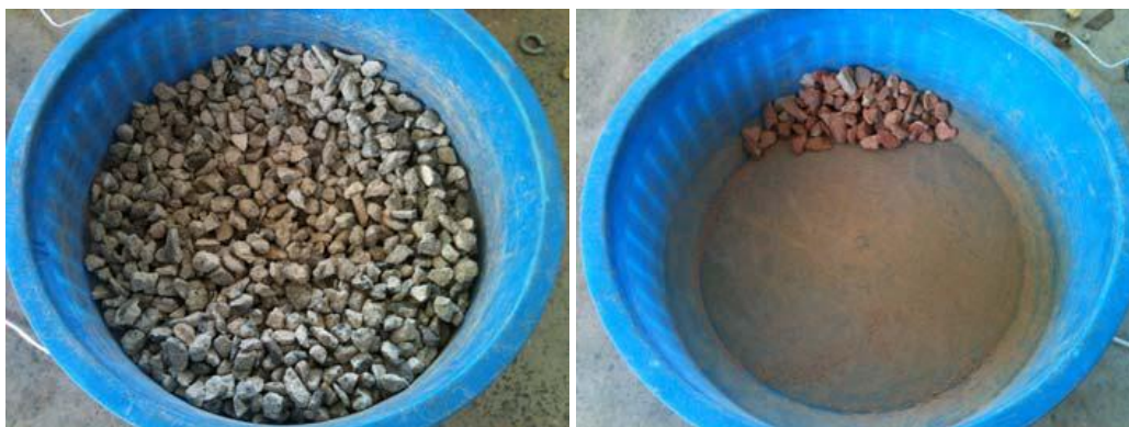
Figura 12: Composição dos materiais retidos na peneira de 12,7 mm (Fonte: Freitas, 2011).
