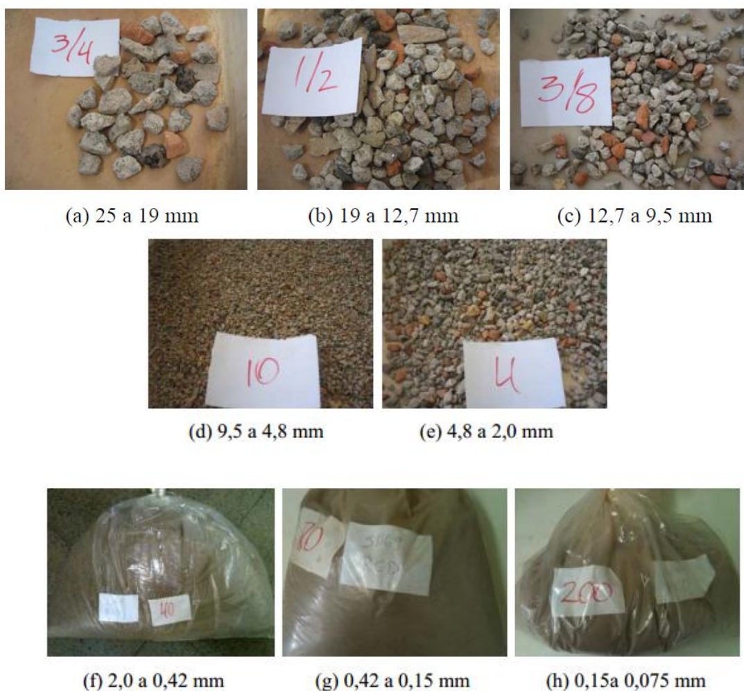
Figura 13: Amostras dos RCD retidos nas peneiras consideradas para o estudo (Fonte: Freitas, 2011).
