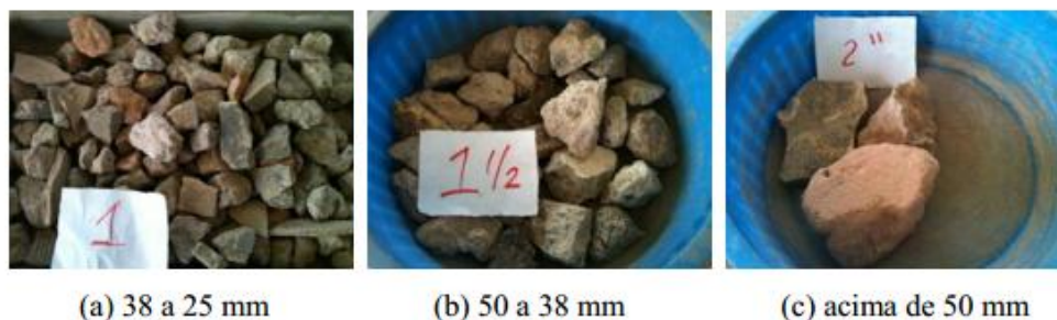
Figura 14: Amostras do material descartado na pesquisa com diâmetro acima de 25 mm (Fonte: Freitas, 2011).
