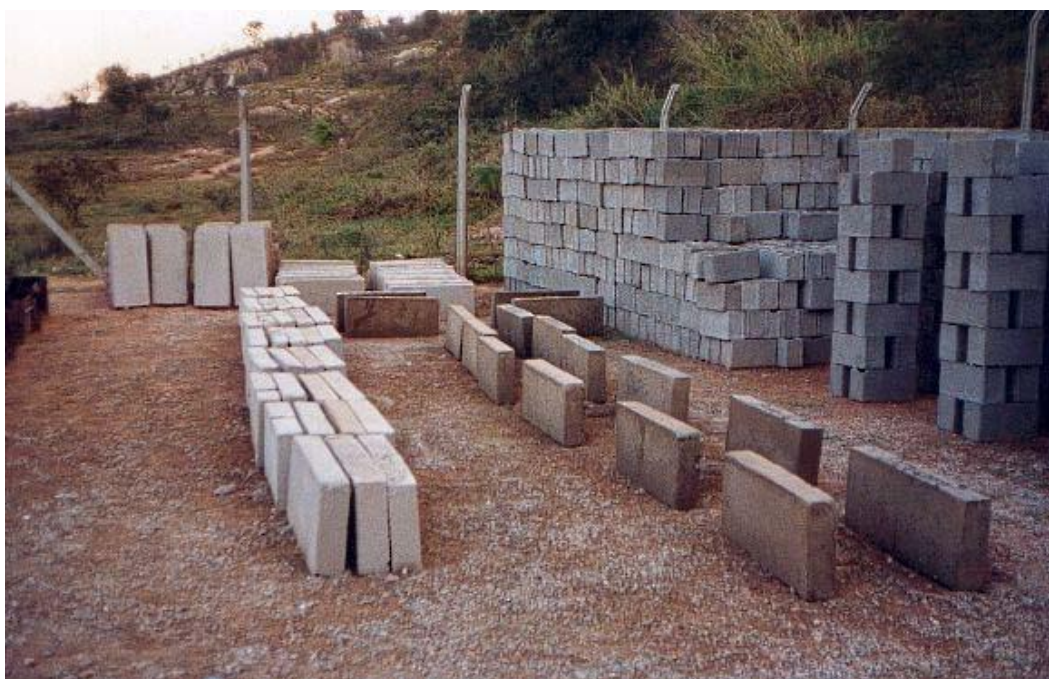
Figura 2: Blocos produzidos com RCD.
