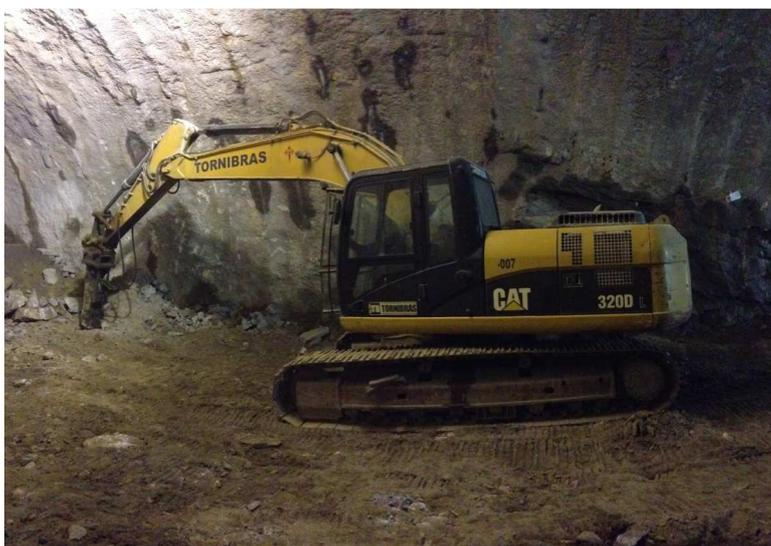
Figura 20 - Rompedor Hidráulico
