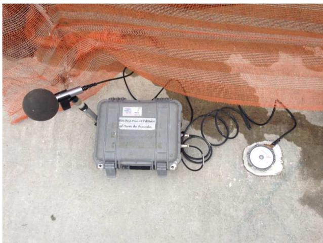
Figura 27 – Monitoramento de vibração, sismógrafo
