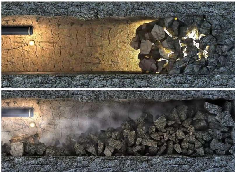
Figura 16 – Detonação da frente de escavação
