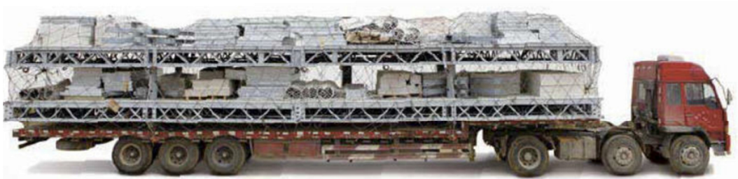
Figura 36 - Padrão de transporte da "main board" e demais sistemas. (www.broad.com, 2014)
