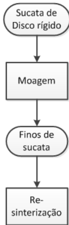
Figura 18. Fluxograma do método de moagem e re-sinterização
