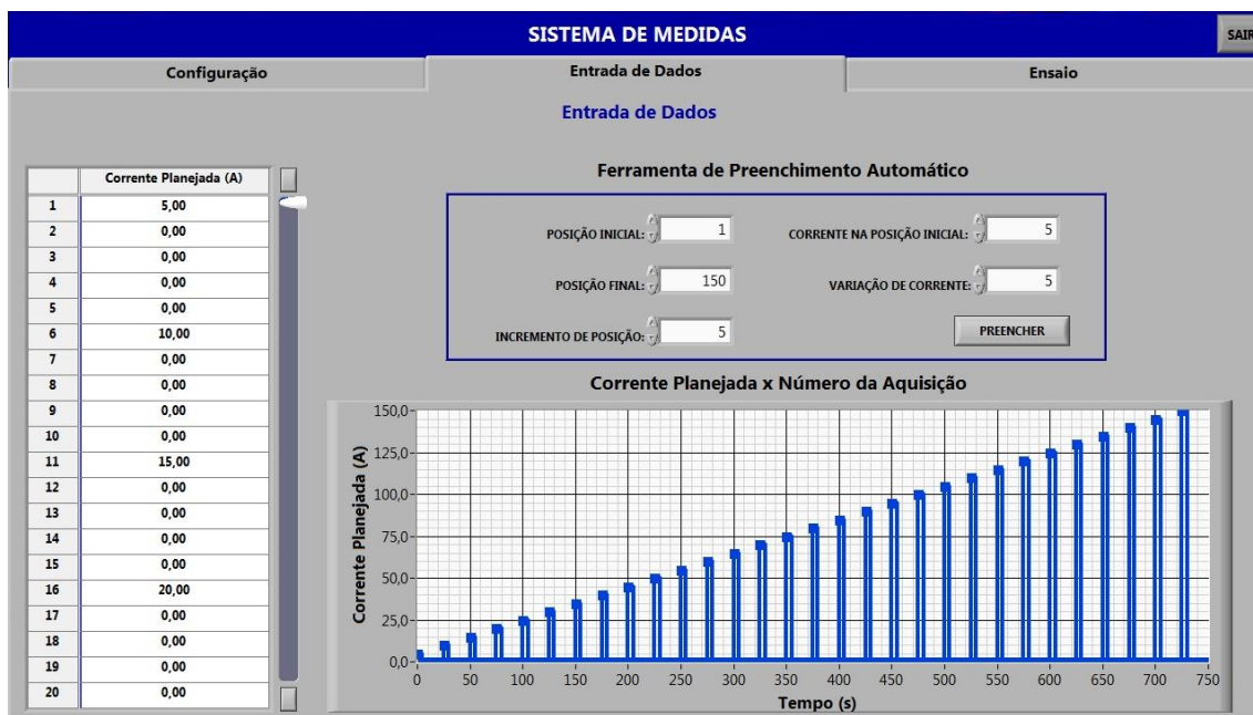
Figura 40 – Painel de Entrada de Dados do programa em Labview
