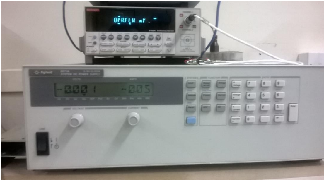
Figura 32 – Nanovoltímetro Keithley 2182A sobre a fonte de corrente Agilent 6671A do LASUP.
