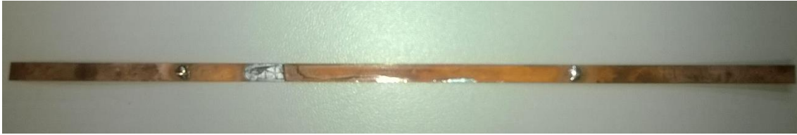
Figura 18 – Foto de uma amostra de dois segmentos de fita 2G SCS4050 da Superpower, com 110 mm de comprimento cada segmento, unidos pela liga de 52%In – 48%Sn com 50 mm de comprimento. A emenda foi feita pelo método de soldagem manual.
