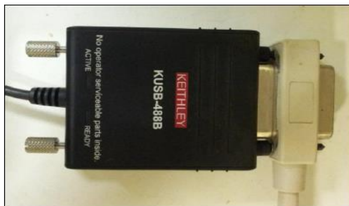
Figura 33 – Placa de aquisição e adaptador GPIB-USB Keithley KUSB-488B.
