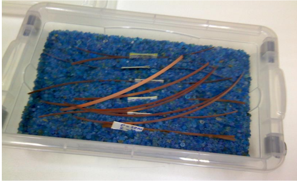
Figura 16 – Recipiente contendo Sílica Gel e os segmentos de fitas 2G soldados.
