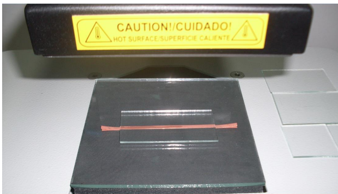
Figura 26 – Imagem de uma amostra de dois segmentos de fita 2G HTS SCS4050 da Superpower totalmente sobrepostos tendo entre eles uma liga laminada de 52%In - 48%Sn com 60 mm de comprimento. A amostra está preste a ser aquecida e pressionada pela chapa metálica superior da prensa térmica.
