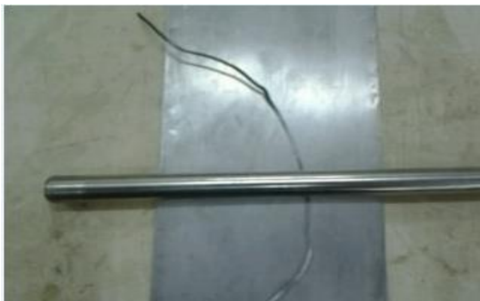
Figura 25 – Um fio de liga 52%In – 48%Sn sendo laminado manualmente.
