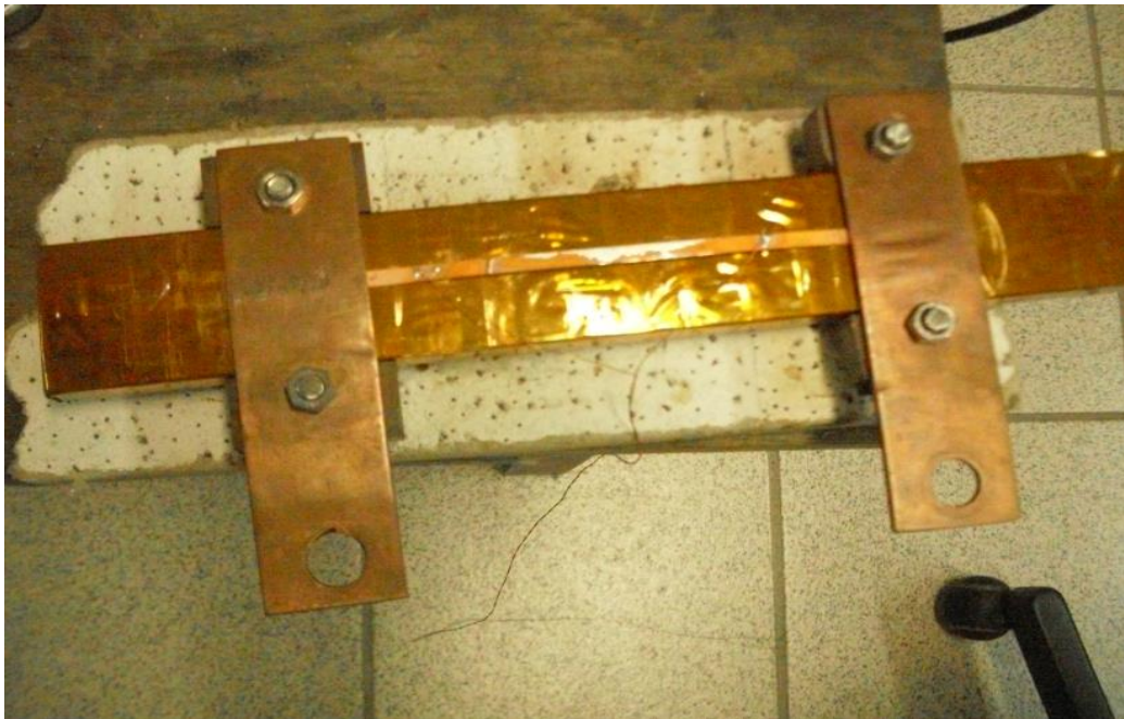
Figura 34 – Foto do suporte para as amostras. Criado pela equipe do LASUP.
