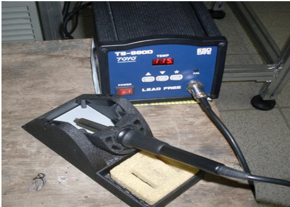
Figura 17 – Foto da estação de solda modelo TS-9800 da Toyo.
