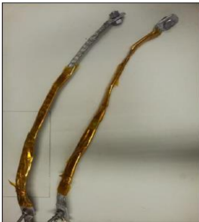
Figura 31 – Cordoalhas de aço com 0,50 m de comprimento e 21,0 mm de largura, envolvidas por um isolante elétrico (Kapton). Figura adaptada de (MARTINS, 2012).
