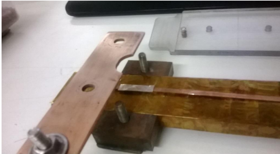
Figura 37 – Foto de uma tira de folha de Índio entre a extremidade de um segmento de fita 2G e a barra de cobre
