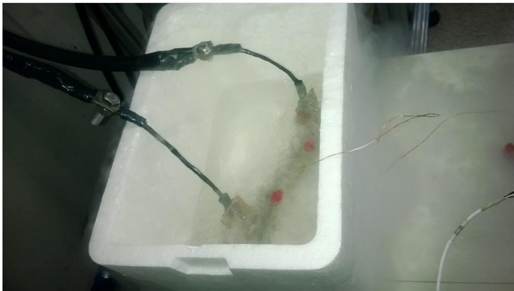
Figura 36 – Foto do suporte adaptado imerso em nitrogênio líquido
