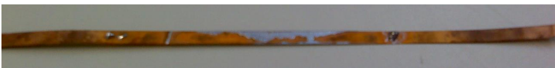
Figura 22 – Amostra submetida ao método de soldagem com dispositivo aquecedor durante 2 min.
