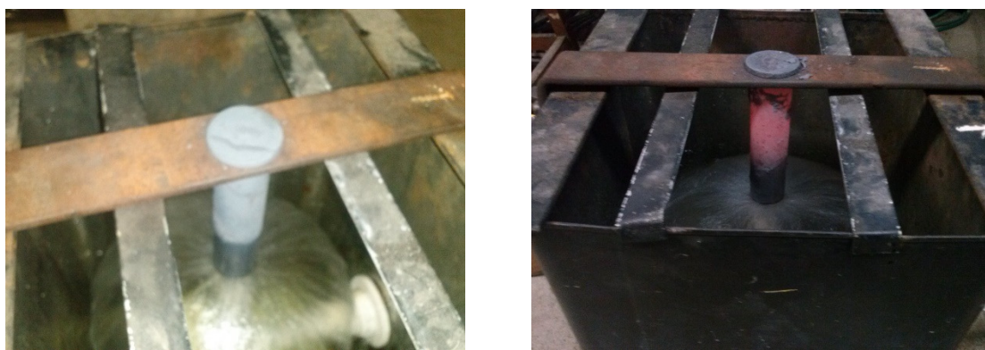
Figura 3.7– Amostra Jominy em processo de têmpera
