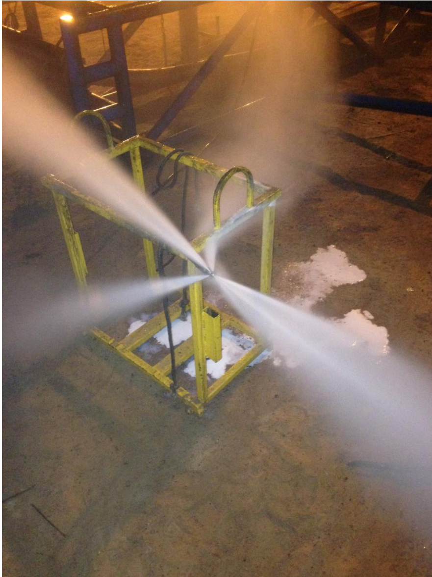
Figura 29 – Jato formado pela bomba tríplex.
