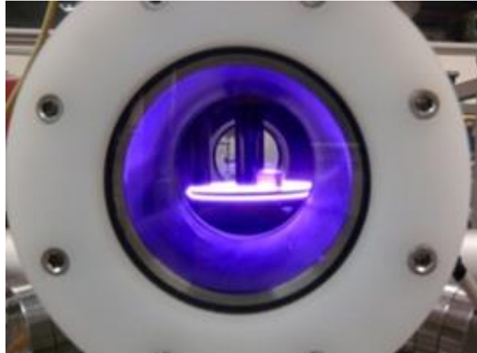
Figura 1 – Imagens do reator em operação durante o processo de Pulverização Catódica
