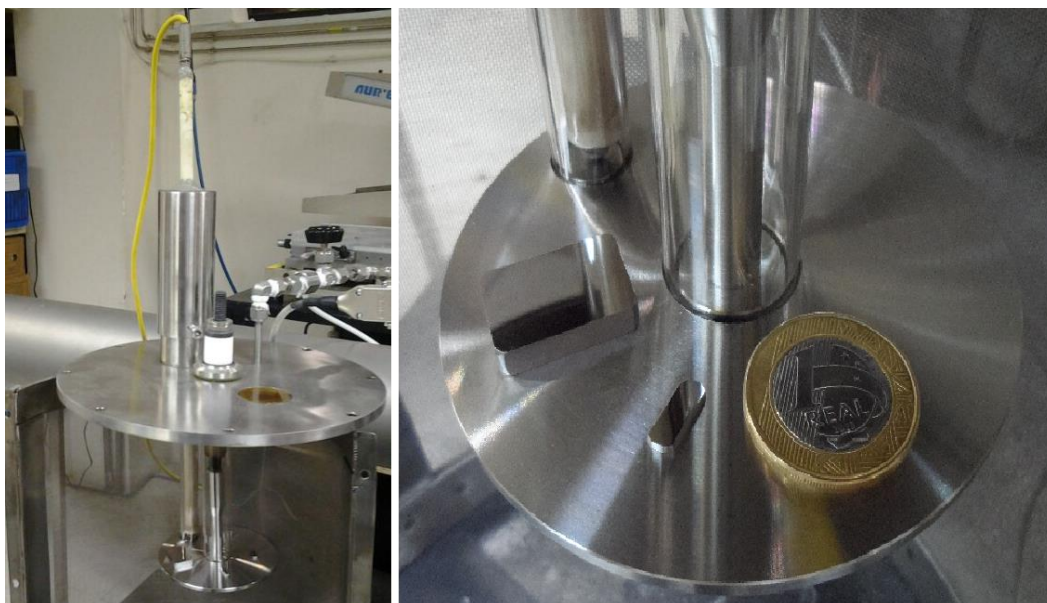
Figura 17 – Imagens do disco do porta – amostras com as amostras devidamente posicionadas.
