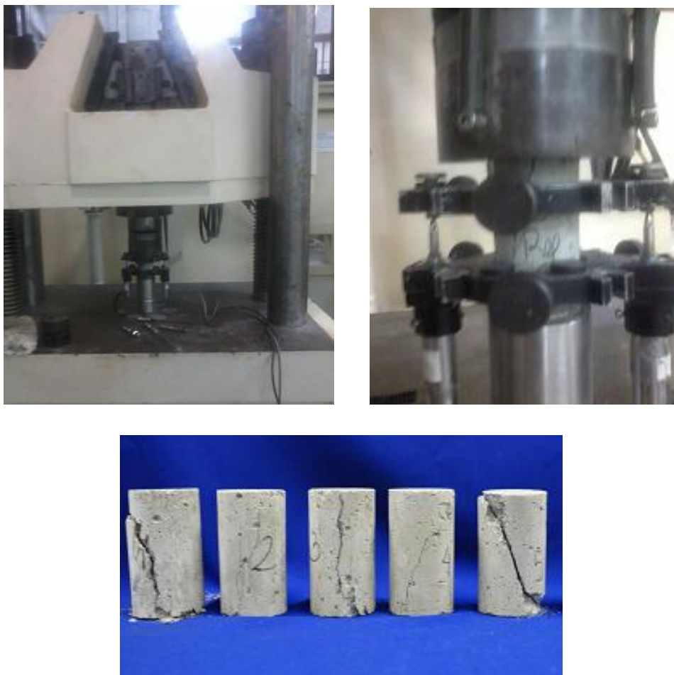
Figura 8- (a) Prensa servo-controlada Shimadzu UH-F1000kNI; (b) Transdutores elétricos no corpo de prova; (c) Corpos de prova após rompimento.
