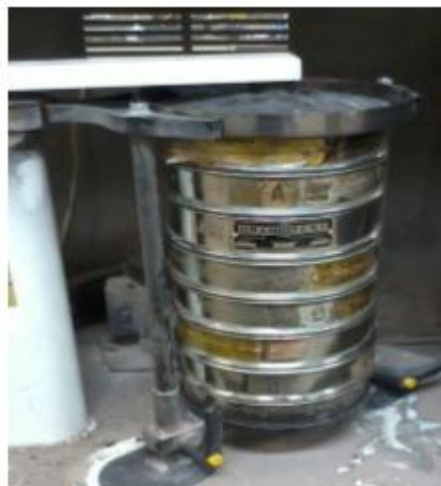
Figura 6 - Agitador mecânico de peneiras – Laboratório Tecnologia Mineral
