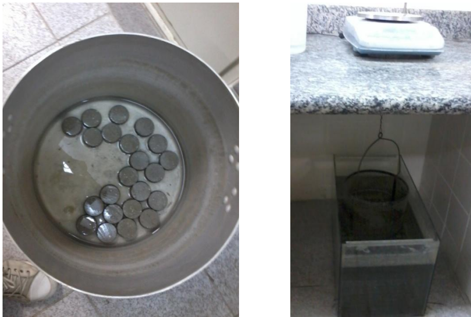
Figura 12 - (a) Amostras esfriando após ebulição; (b) Balança hidrostática
