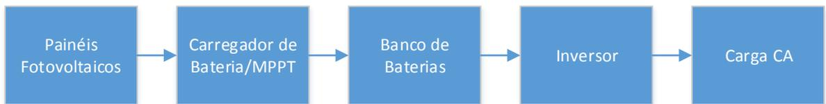
Figura 1.2: Diagrama do sistema fotovoltaico utilizado
