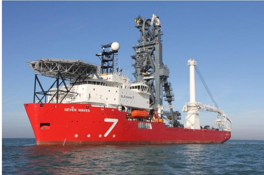
**Figura 40 - Embarcação com torre para lançamento J-Lay.**
