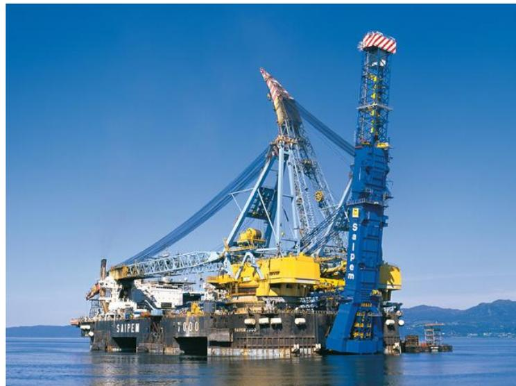
**Figura 41 - Saipem 7000 – Semi-sub com torre para lançamento J-Lay.**
