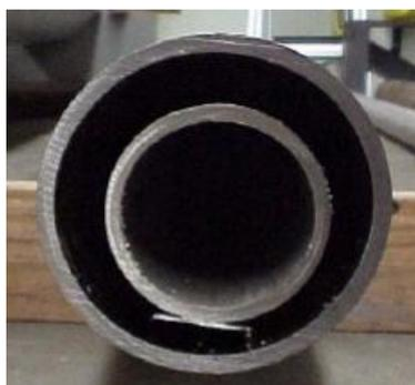
**Figura 2 – Configuração de sistema PiP**
