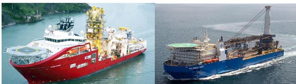
Figura 24 – Navios PLSVs J-Lay e S-lay respectivamente
