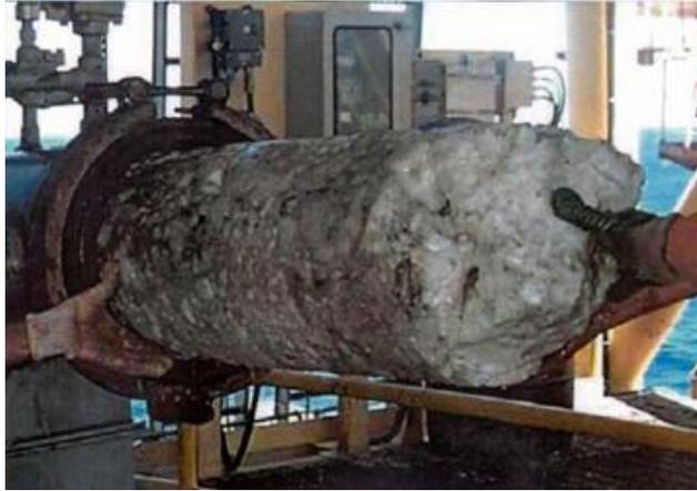
Figura 19 – Flowline obstruído devido à formação de parafina
