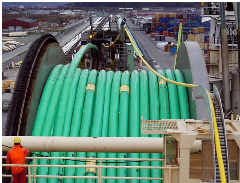
**Figura 48 - Carretel de um navio sendo carregado em uma spoolbase**
