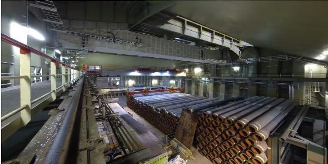
**Figura 31**–Carga estocada dentro de embarcação PLSV S-lay
