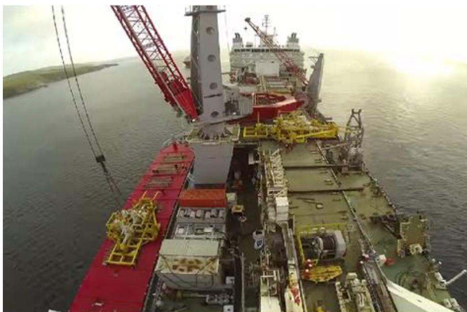
**Figura 30 – Transbordo de carga de navio supridor para navio PLSV S-lay**
