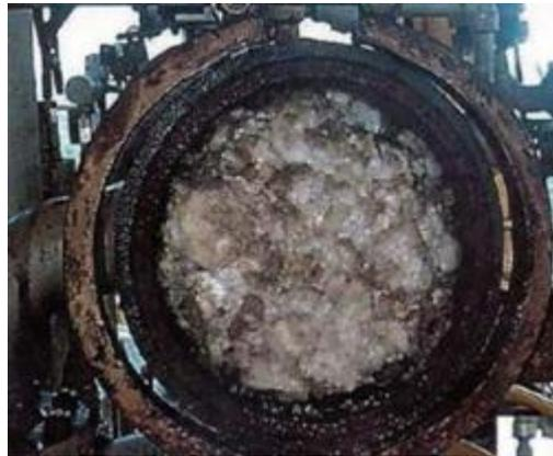
Figura 20 – Seção de flowline obstruída por parafina
