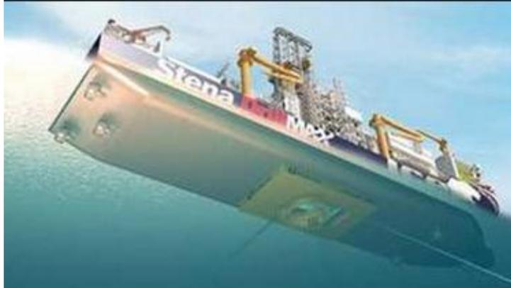
Figura 43 - Ilustração do *Moonpool* de um navio sonda
