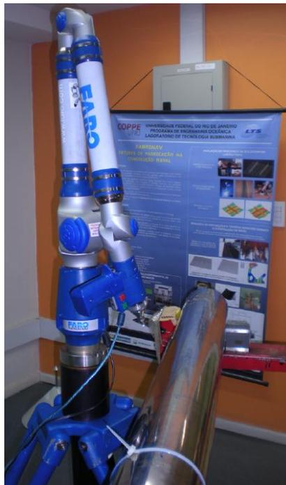
**Figura 11 – Instrumento usado para medir a ovalização**
