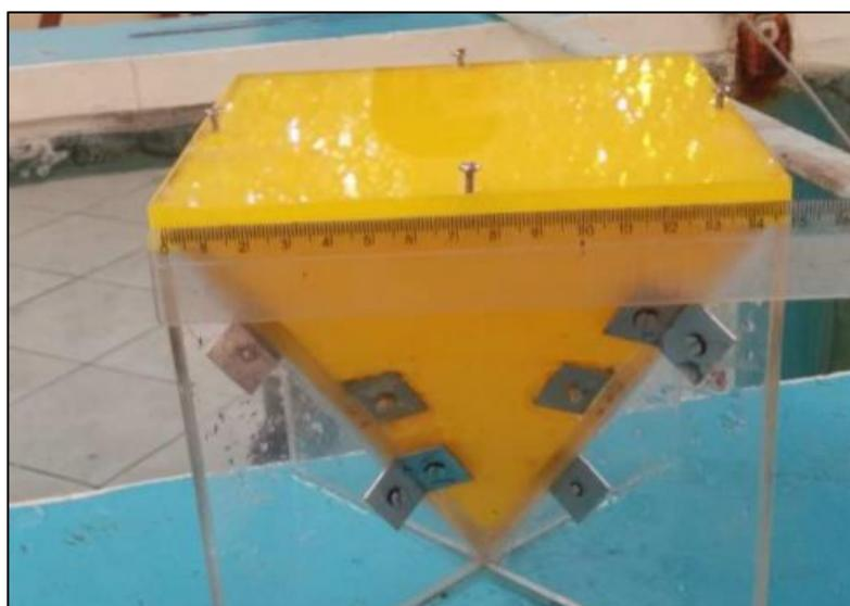
**Figura 3.1: Protótipo com abas de acrílico (transparentes) em escala 1:40 para testes iniciais.**
