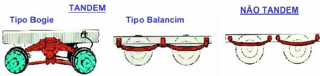
Figura 3.8: Suspensões de eixos
