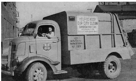
Figura 2.5: Primeiro veículo compactador de RSU
