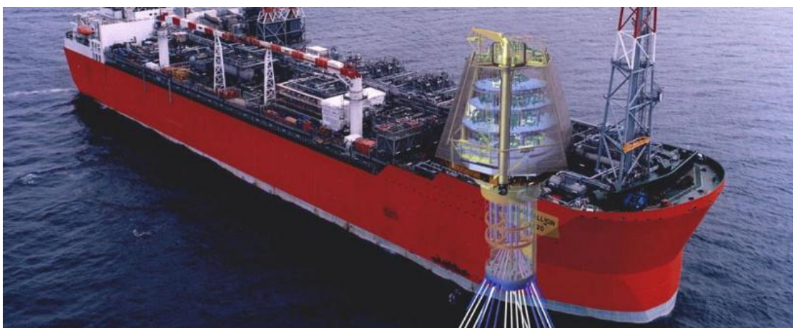
Figura 4 - Sistema de Ancoragem Turret Interno
