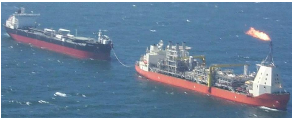
Figura 12 - Mangote Flexível em operação Offloading
