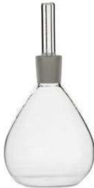
Figura 13 - Exemplo de picnômetro usado neste tipo de ensaio (imagem retirada do site da Qualyta lab)
