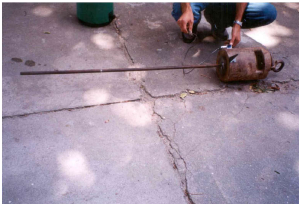
Figura 4: Imagem de um martelo utilizado em sondagens (DANZIGER, F. –Notas de aula, 2015).
