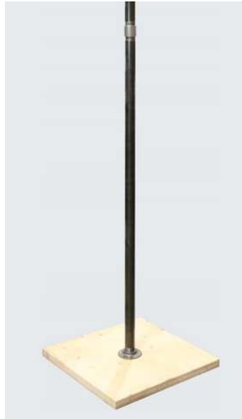
Figura 17 - Exemplo de Placa de Recalque
