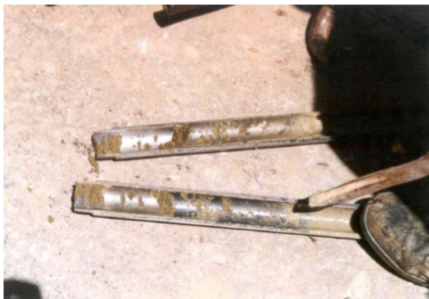
Figura 5: Imagem de um amostrador padrão de sondagem(DANZIGER, F. –Notas de aula, 2015).
