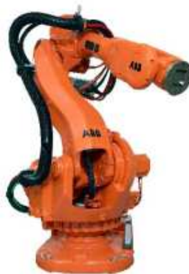
Figura 2 - Manipulador serial modelo ABB IRB6600, retirado de [4].
