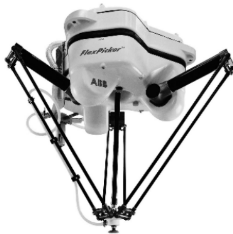
Figura 1 - Manipulador paralelo modelo ABB IRB 340, retirado de [13].
