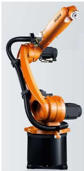
Figura 19 - Manipulador KR 10 R1420 com 6 graus de liberdade, retirado de [18].
