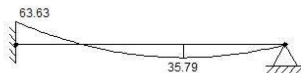
Figura 86 – DMF do vão V4b com engastamento perfeito no apoio interno
