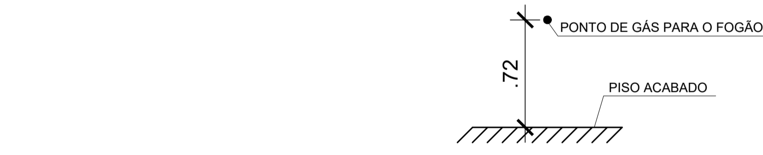
6 PONTO DE GÁS DO FOGÃO ESCALA 1:25
