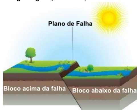
Figura 10 Esquema de uma falha geológica que pode dar origem a um terremoto 15
