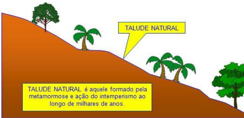
Figura 6 Ilustração e definição talude 10
