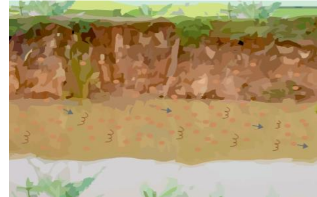
Figura 21 Erosão de margem de rio. 8
